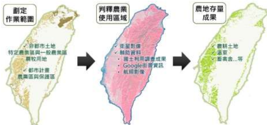
圖 2-43、分析現存農業使用地之作業流程
