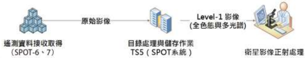
圖 2-2、衛星影像接收流程
