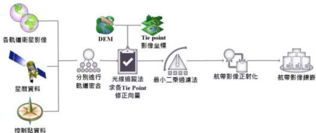
圖 2-3、影像正射化處理流程
